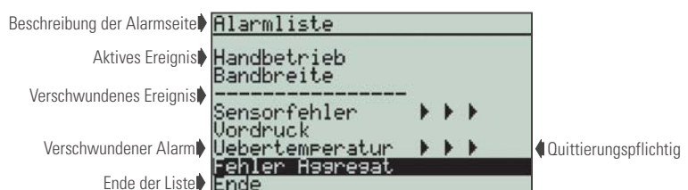
Fig. 9 Alarm- und Ereignisliste (VALARM)
